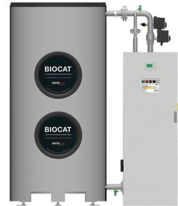
BIOCAT KS 7.5D Kalkschutzanlage, geeignet zum Einbau in die Kaltwasserversorgungsleitung, bei einer Gebäudegröße von bis zu 340 Wohneinheiten (max. 750 Personen), max. 26.250 Kubikmeter/Jahr.
