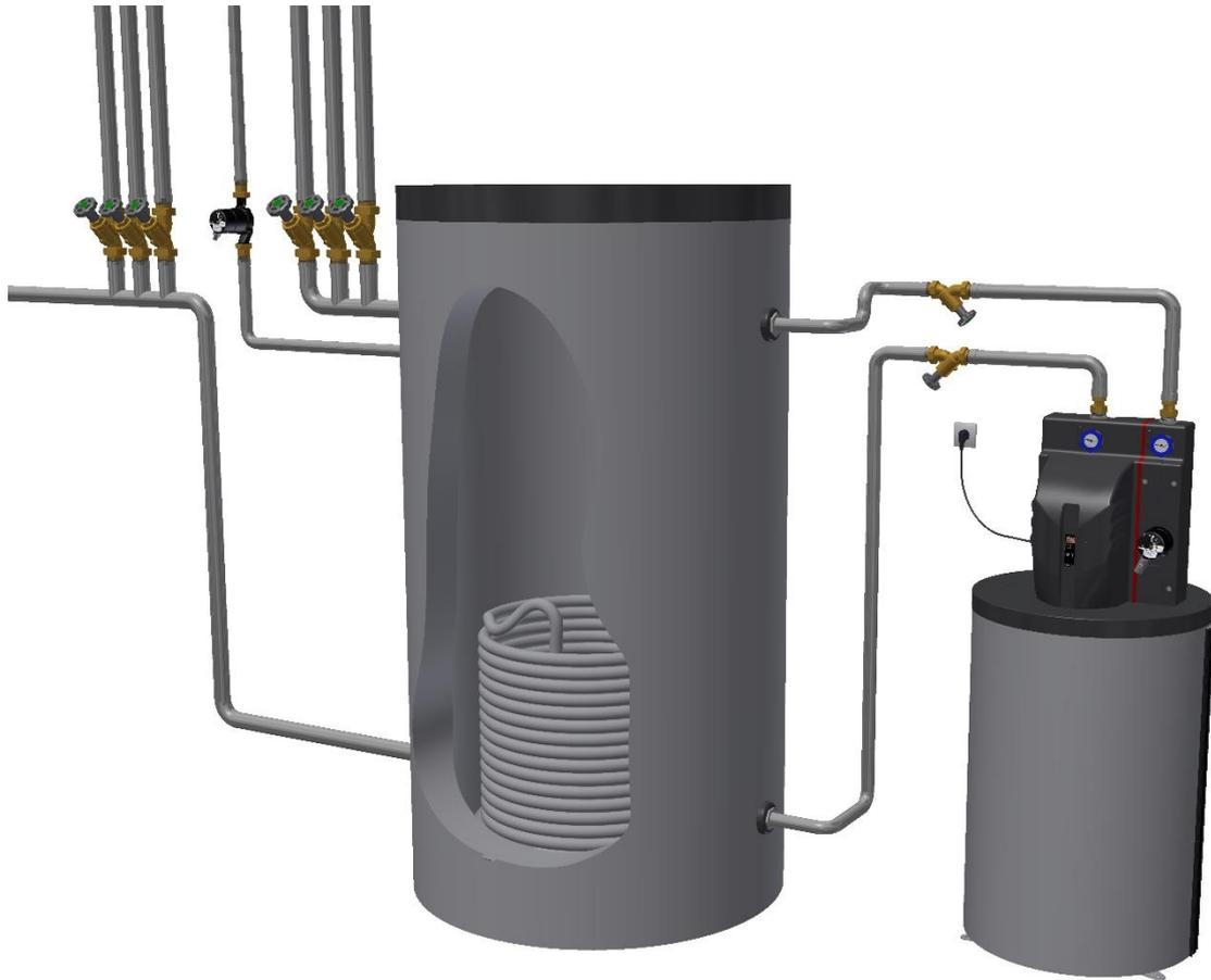
Einbaubeispiel: BIOCAT WS 10 mit Umwälzpumpe, Wasserzähler und Wartungshähnen in die Umgehungsleitung um den Warmwasserspeicher einer zentralen Trinkwassererwärmungsanlage.
